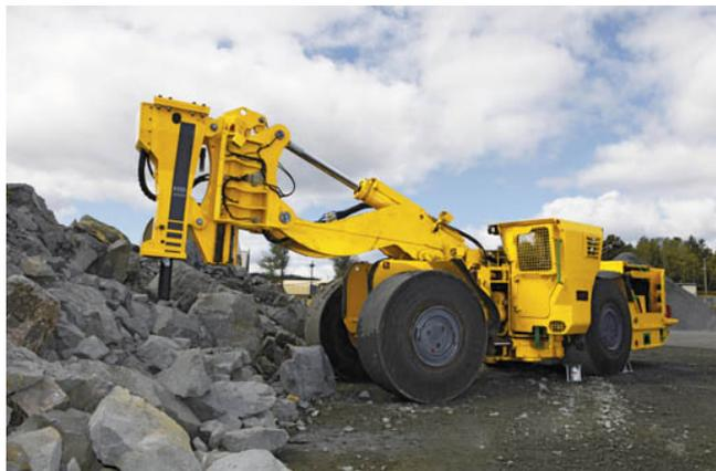
Os rompedores de carreta da Atlas Copco são divididos em três classes: HB (Heavy Breaker), MB (Medium) e SB (Solid Body), com diferentes variações de potência, totalizando 40 modelos de rompedores.
