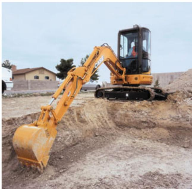
*Case Construction Equipment lança mais uma linha de produtos, as miniescavadeiras, nos modelos CX27B, CX36B e CX50B, com motor de potência líquida de 21,3 hp a 39,8 hp e força de escavação da caçamba de 2.881 kgf a 5.048 kgf*
