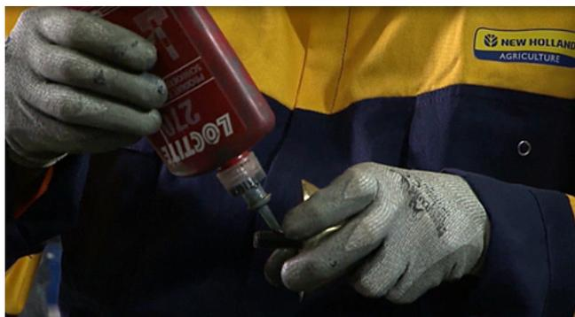
Colheitadeira CR 1990, da New Holland, utiliza mais de 20 tipos diferentes de adesivos anaeróbicos da Henkel, específicos para altas temperatura e pressão
