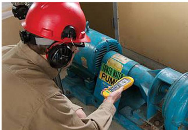
O Fluke 805 FC oferece melhor repetibilidade e precisão para verificar o funcionamento de motores e de outros equipamentos giratórios. Agora, os técnicos podem compartilhar medições com os membros da equipe em tempo real
