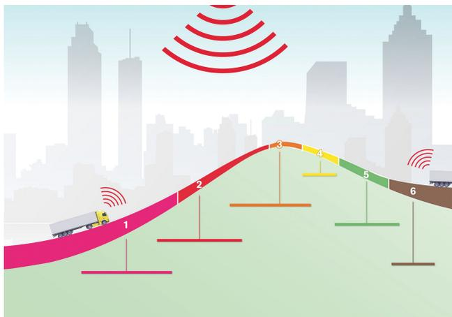
O FH já sai da linha de produção com o I-See instalado. Uma das mais avançadas tecnologias já desenvolvidas pela marca para tornar o veículo ainda mais inteligente, diminuir o consumo de combustível e ajudar o motorista na condução do caminhão, o I-See coleta dados de topografia da estrada para, em viagens futuras, gerenciar de forma mais eficiente a aceleração, as trocas de marcha e o uso do freio motor, e assim baixar o consumo de diesel.
