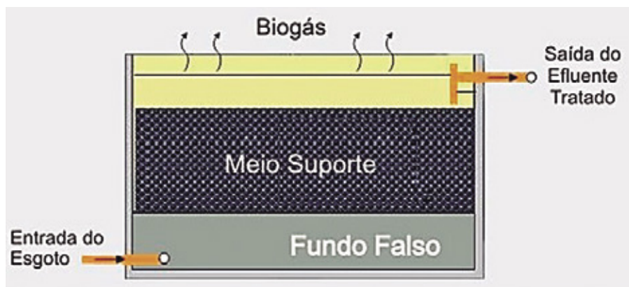
Figura 4 - Filtro Anaeróbio de Fluxo ascendente, vista em corte
