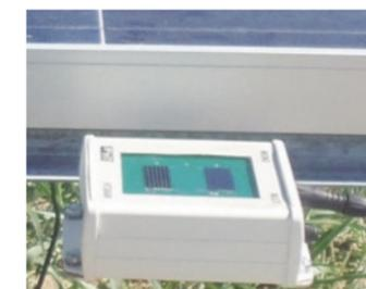
Figura 18 - Detalhe de instalação da célula de irradiação
