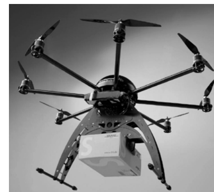
Figura 2 - VANT de oito hélices considerado no estudo
