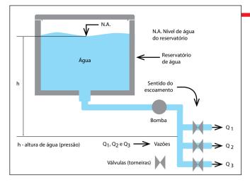
Como vimos, a primeira providência para interpretar o funcionamento do sistema de água é ver quanto se tem de pressão (altura de água). Na Hidráulica Predial substituindo o dinheiro temos a altura de água que dá pressão. A vazão de água Q é a comida. Vazões pequenas são as comidas baratas. Vazões grandes são as comidas mais caras.
