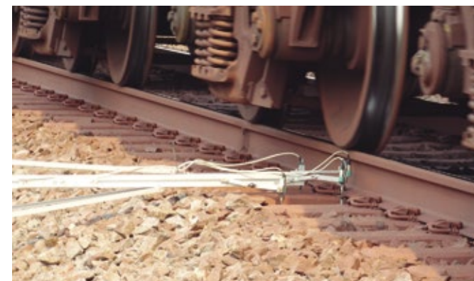
Detalhe do Equipamento de medição de deslocamentos da via concebido pela POLI-USP
