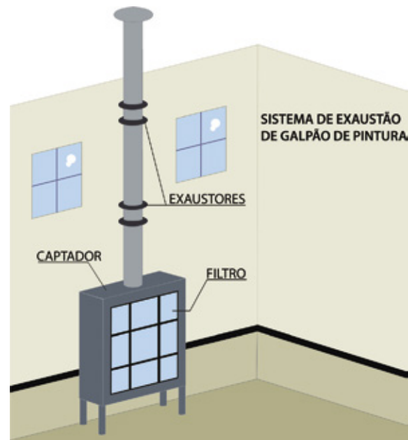
Figura 5 - Sistema de exaustão de cabine de pintura
