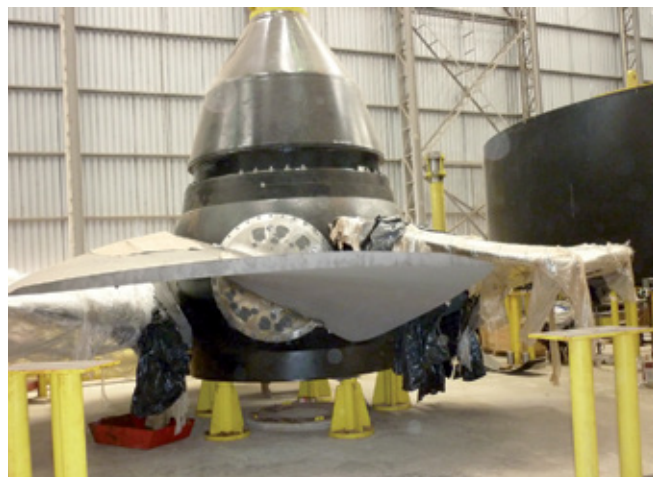
Figura 4 - Vista das pás de uma turbina tipo bulbo - Usina Hidrelétrica de Santo Antônio
