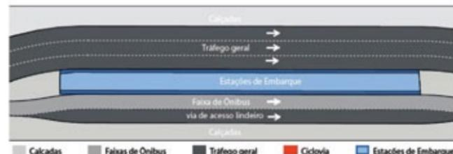
Figura 12 - As estações tipo ilha têm implantação separada das calçadas
