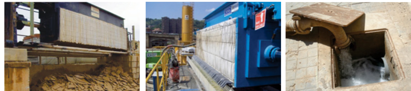
Tratamento de lodos descartados com filtro prensa
