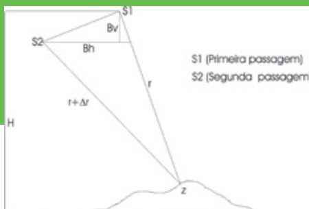
Figura 7 - Geometria de radar interferométrico, duas passagens
