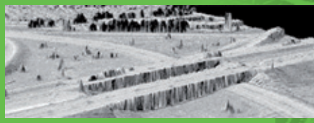
Figura 2 - Aplicação em obras viárias para projeto ou para detecção rápida de interferências na faixa de domínio, cálculo de volumes de corte e aterro
