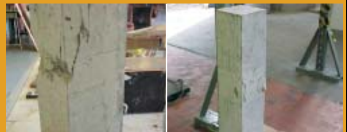
Figura 17 e figura 18 - Rupturas do modelo reduzido 2-50-35 com espessura de 7cm e 14cm
