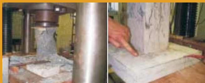
Figura 21 e figura 22 - Ruptura do pilar superior de outro modelo 4-50-35 e pequena fissura na laje após ruptura do modelo 4-40-28
