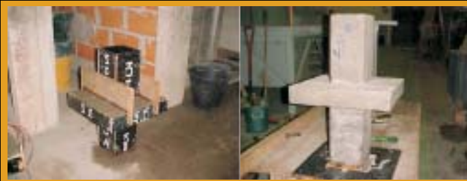
Figura 7 e figura 8 - Forma completa do modelo reduzido 3 (50 e 35 MPa) para a 3.ª etapa de concretagem (pilar superior) e modelo 3 endurecido (50 e 35 MPa)
