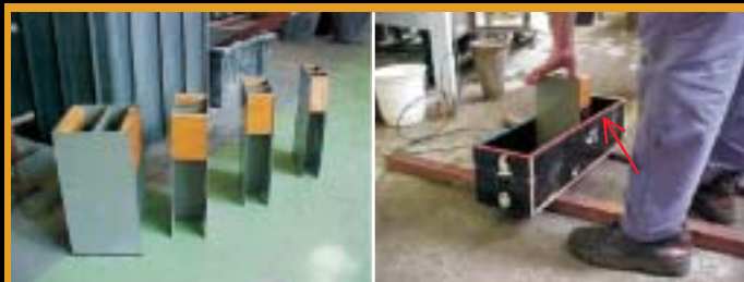
Figura 3 e figura 4 - Espaçadores com espessuras de 14, 7, 6 e 4,5cm e montagem do modelo reduzido 2-50-35- \epsilon_3 (espessura de 7cm)
