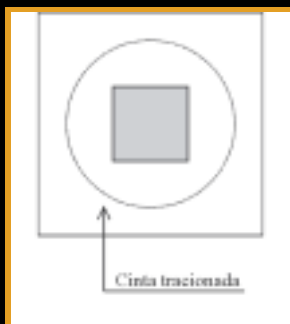
Figura 28 - Pilar e laje com cinta totalmente tracionada
