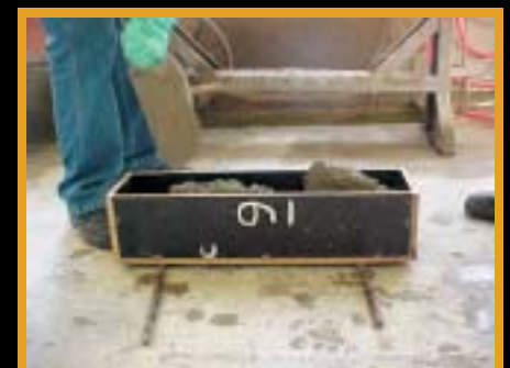
Figura 2 - Concretagem do modelo reduzido 1-50
