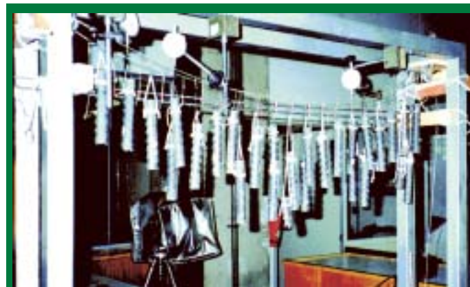
Figura 2 - Arranjo e estrutura experimental com relógios comparadores de centésimo de milímetro (LEM - EPUSP, 1994)
