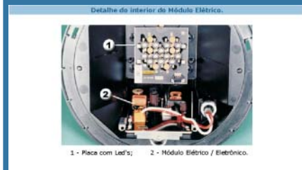
Figura 3 - Módulo elétrico de semáforo a LED
