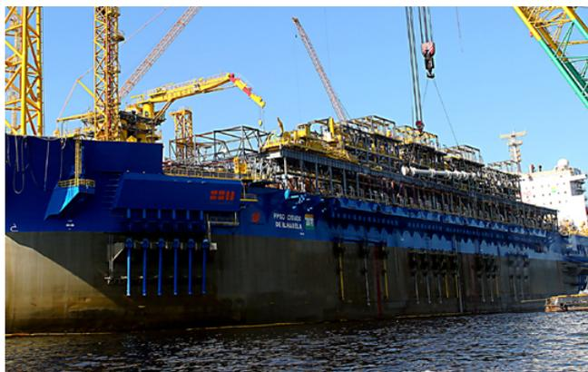
O FPSO Cidade de Ilhabela, unidade flutuante de produção, armazenamento e transferência de petróleo e gás programada para operar no campo de Sapinhoá, na Bacia de Santos, chegou ao estaleiro Brasa, em Niterói (RJ), para conclusão das operações de içamento e integração de 13 módulos da sua planta de processamento. A nova plataforma foi convertida a partir de um navio petroleiro no estaleiro CXG, na China.
