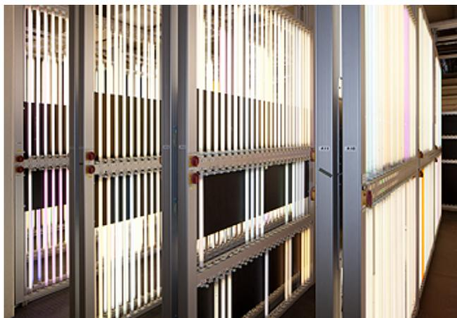
Testes realizados na Alemanha apontam que três das quatro lâmpadas fluorescentes T8 Longlife da primeira linha de produção do ano 2000 bateram o recorde de operação, com perda de apenas 15% de luminosidade
