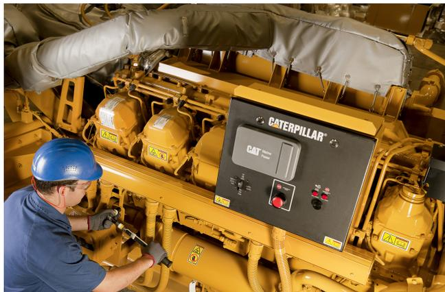
Grupo Gerador Cat 3512 de Propulsão Diesel-Elétrica (DE) fornecido para navios de suprimentos para plataformas OSV – Offshore Supply Vessel
